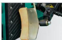
Destalonador pneumático com capa de proteção que facilita a descolagem do pneu sem danificar a roda.
