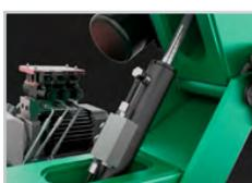
Cilindro do braço de elevação, de qualidade superior, equipado com dispositivo de proteção, aumentando a segurança na operação.
